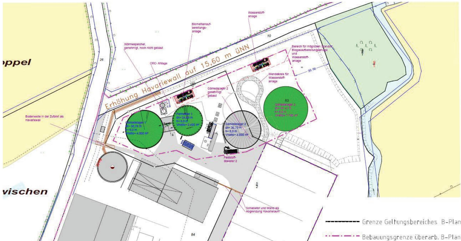
**Abb. 5:** Darstellung der Biogasanlage mit dem geplanten 3. Gärrestlager, der neuen Position des Gärrestlagers 2 sowie in rot dargestellten und lila beschrifteten geänderten Vorhabenbestandteilen. Eine neue Zuwegung ist grau gepunktet eingezeichnet. (erstellt durch DAS-IB GmbH, Stand 02.08.2023)
